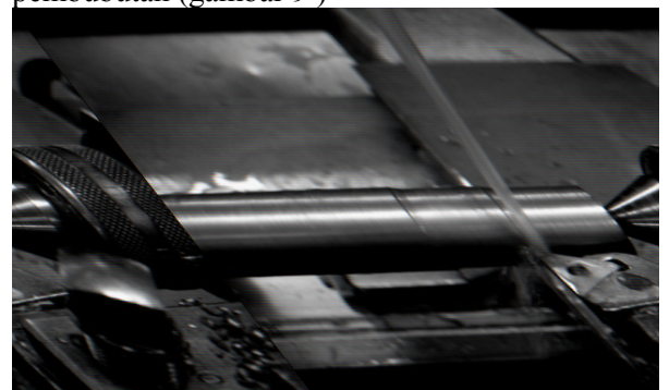
Gambar 10. Proses pemotongan pahat model insert dari baja 34CrNiMo6
